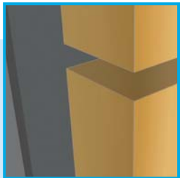
Joints creux en applique Hollow joint
