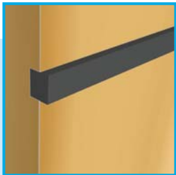
Joints avec jonc en surépaisseur Joint with thicker plastic filler rod
